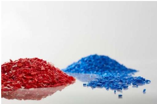
*Le tri par capteur sépare avec précision les paillettes de PP rouges et bleus*
