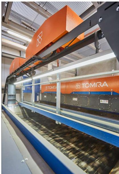
AUTOSORT™ et GAIN™, technologie d'apprentissage profond pour la purification des copeaux de bois.
