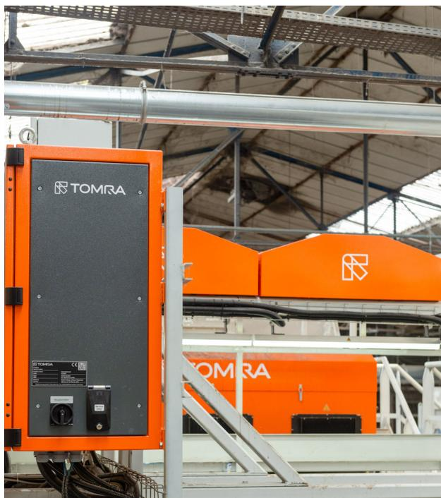
Sur la ligne de production, l'une des machines équipée en **GAIN Pet Cleaner**, intervient sur la dernière étape de tri, pour la purification des flux et l'éjection du **PET blanc opaque** ; la seconde machine équipée de GAIN, récupère les faux rejets, pour les récupérer et les remettre dans le flux positif, afin de maximiser la matière produite en évitant les pertes.
